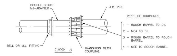
A.C. = ASBESTOS CEMENT
